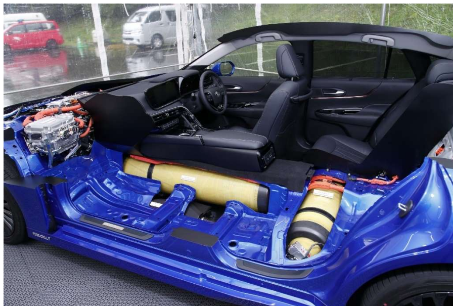
Figura 22 - Vista interna de um Mirai, exibindo os tanques de hidrogênio
