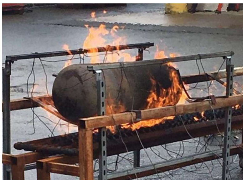
Figura 24 - Tanque de H 2 em teste de incêndio
