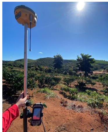
Figura 5. Coleta de ponto em receptor GNSS RTK.
