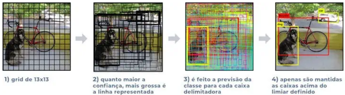
Figura 8 – Funcionamento de uma detecção de objetos com uma rede YOLO.
