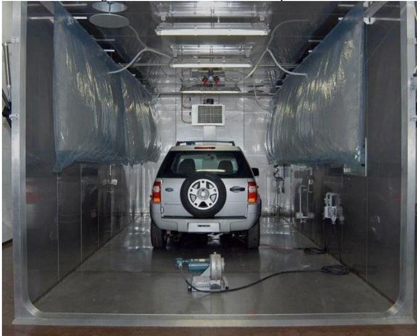
Figura 11 - Câmara SHED montada para teste.
