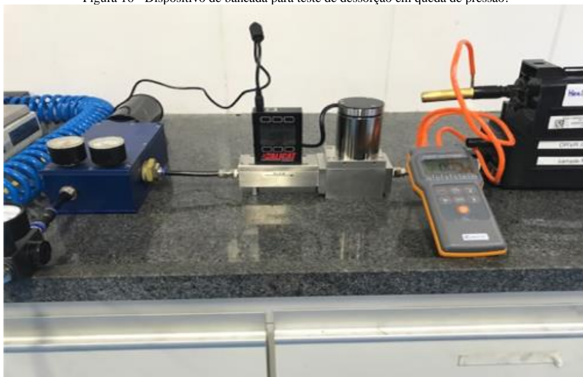
Figura 16 - Dispositivo de bancada para teste de dessorção em queda de pressão.
