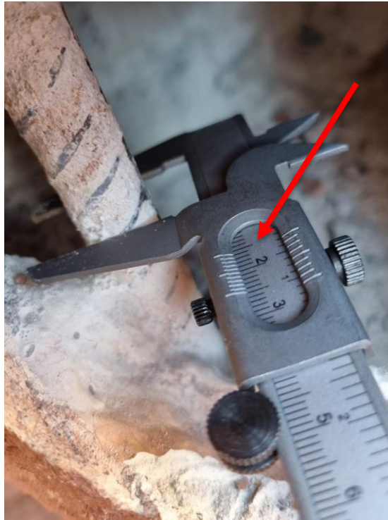
Figura 20 – Identificação bitola aço estaca 1
