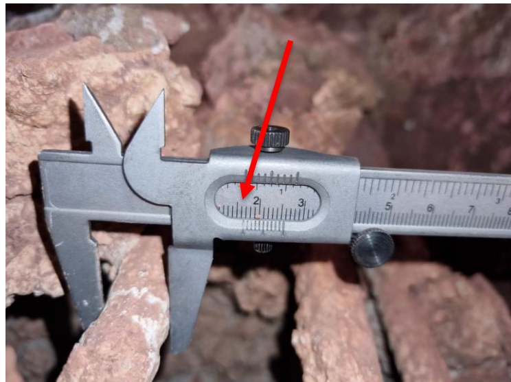
Figura 23 – Identificação bitola aço estaca 3
