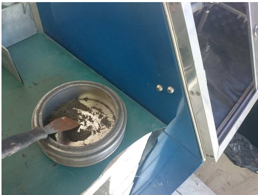
Figura 16 - Amostra pulverizada de resíduos realizada em moinho de panela.
