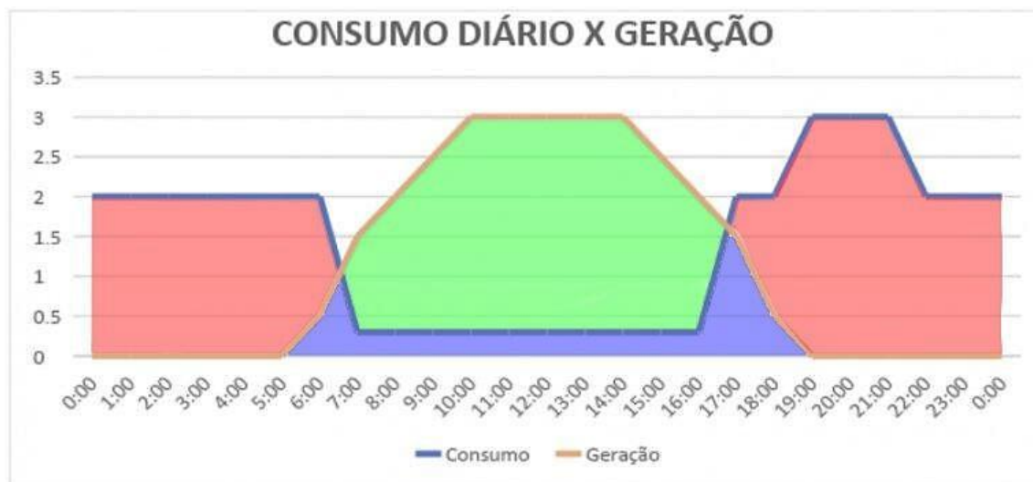
Figura 15 - Representação gráfica da geração simultânea, injeção e consumo ativo.
