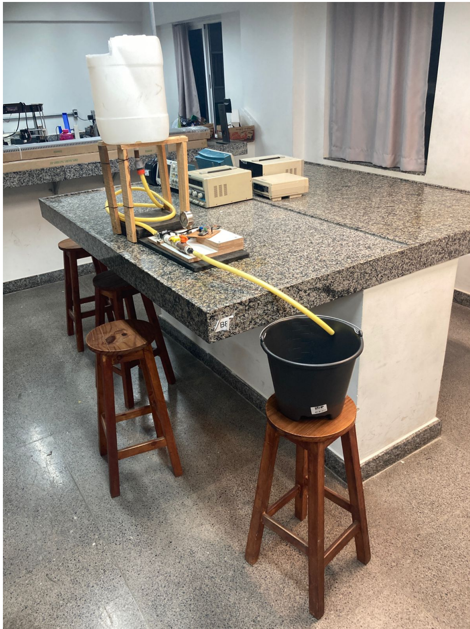
Figura 24 – Reservatório de testes usado para calibração.
