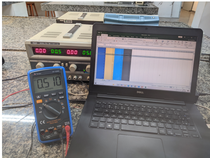
Figura 17 – Multímetro e fonte ajustável durante os testes .
