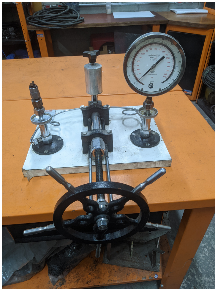
Figura 20 – Bomba de Calibração de Manômetros Salcas S600 usada nos testes.
