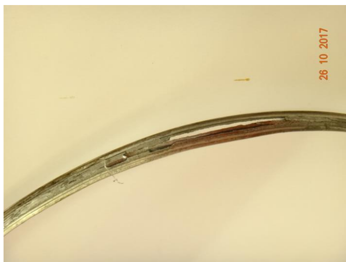
Figura 36 - Fotografia de junta dupla-camisa com falha generalizada após sucessivas tentativas de reaperto dos flanges
