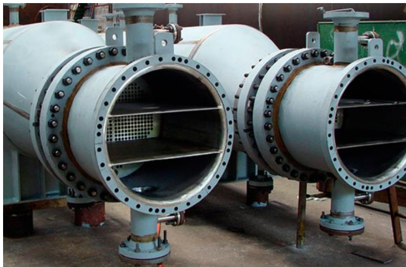
Figura 3 - Dois trocadores de calor do tipo casco e tubos, sem as tampas dos carretéis.
