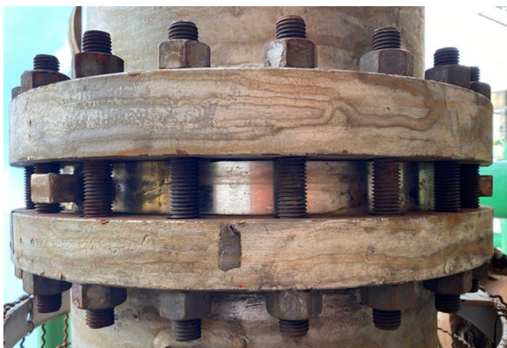
Figura 13 - Espelho fixo de feixe tubular em aço inoxidável, montado entre flanges de aço carbono em um trocador de calor do tipo casco e tubos em um trocador de calor do tipo casco e tubos
