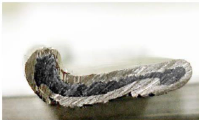
Figura 17 - Junta dupla camisa deformada por dilatação diferencial dos flanges
