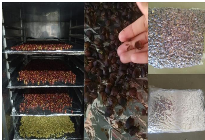
Figura 3- Secagem das cascas de café ( Coffea arábica ) em secador convectivo.
