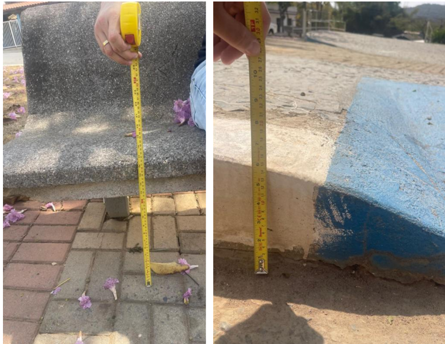
e) Medição da altura dos bancos da praça (41cm) f) Aferição da altura do meio feio (14cm)
