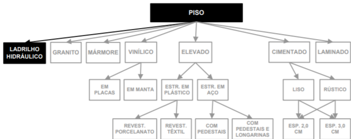
Figura 3– Árvore de composições dos serviços de piso
