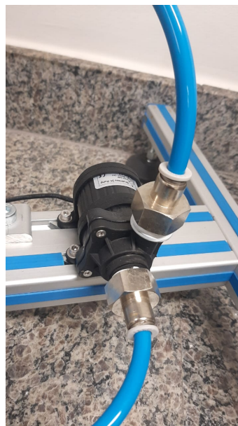
Figura 8 – Bomba de recirculação.
