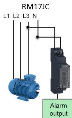
Figura 7 - Esquema de Ligação RM17JC.
