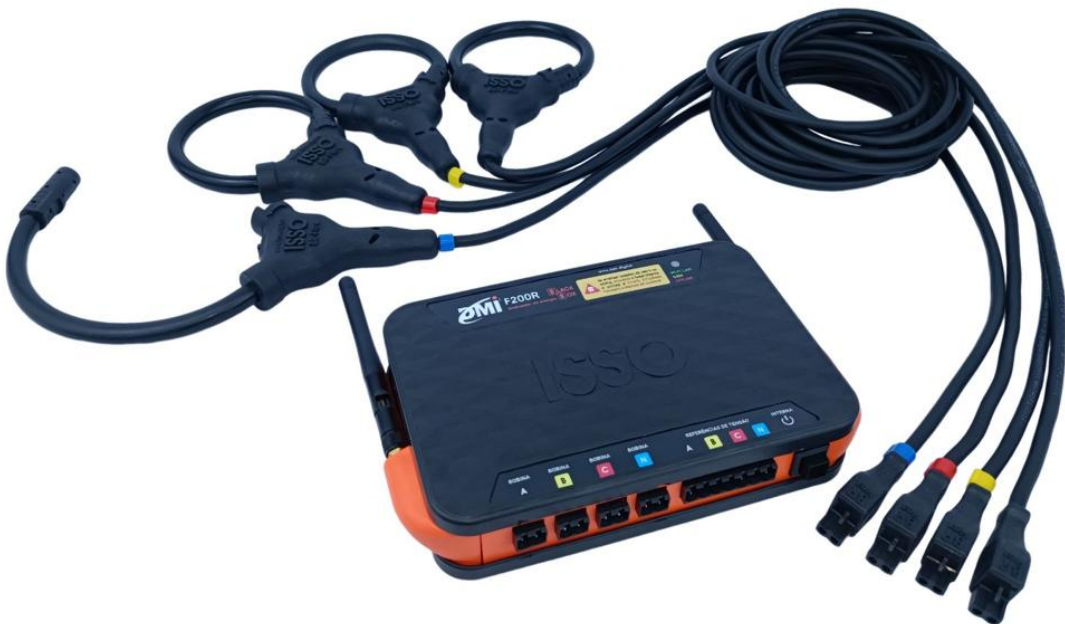
Figura 12 - Analisador medidor de energia DMI F200R Black Box
