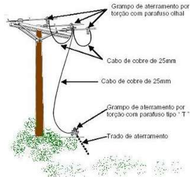
Figura 11: Exemplo de aterramento temporário
