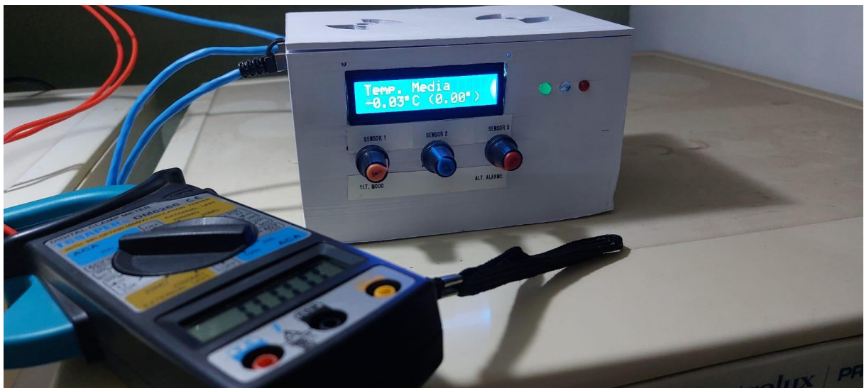
Figura 45: Temperatura média após 90 minutos e abertura dos relés.
