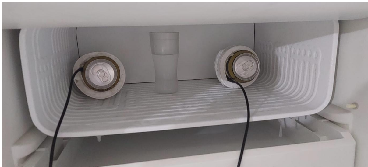
Figura 50: Copo de 200 ml adicionado ao congelador para teste de congelamento.
