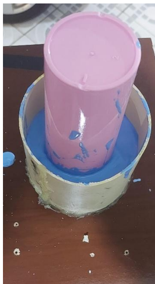
Figura 29: Mistura de borracha de silicone já homogênea despejada no molde para a formação do anel
