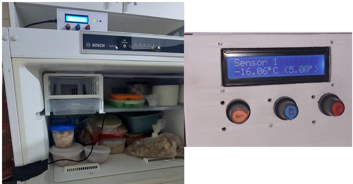
Figura 37: Valor medido pelo sensor dentro do freezer.
