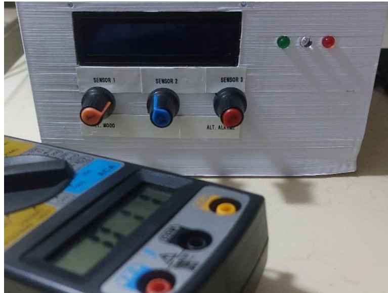
Figura 56: Sistema UaiGelô desligado, mas geladeira funcionando via relé do modo Control .
