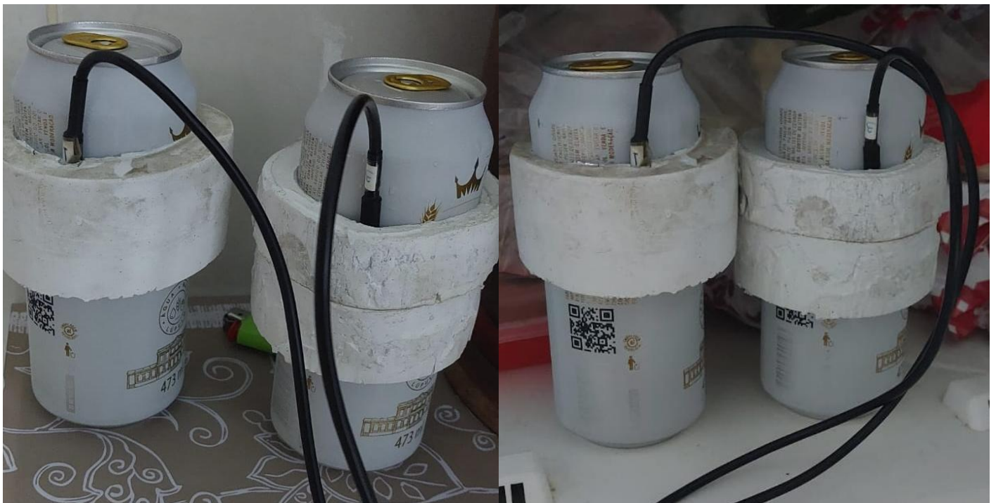
Figura 38: Sensor da esquerda com manta térmica/ sensor da direita sem manta térmica
