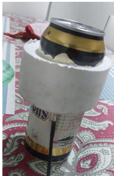
Figura 57: Sensor 1 acoplado à lata para o teste no modo Watch .
