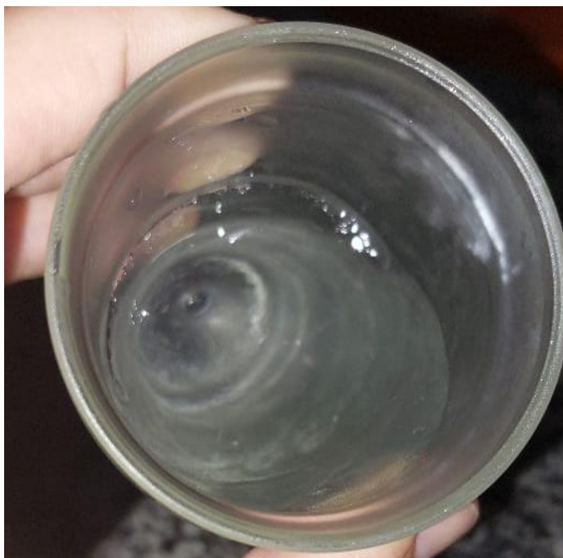
Figura 51: Início da solidificação da água após 2 horas.
