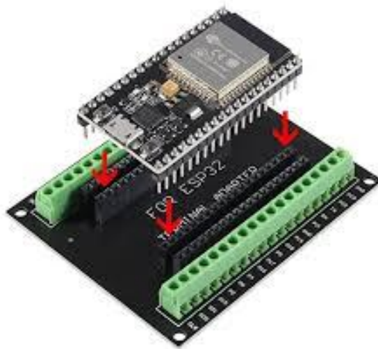
Figura 9: Conexão do ESP32 na placa de expansão.
