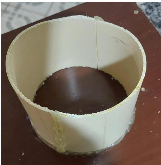
Figura 25: Cano de PVC de 100 mm cortado e fixado à base de madeira com cola quente para formar o molde
