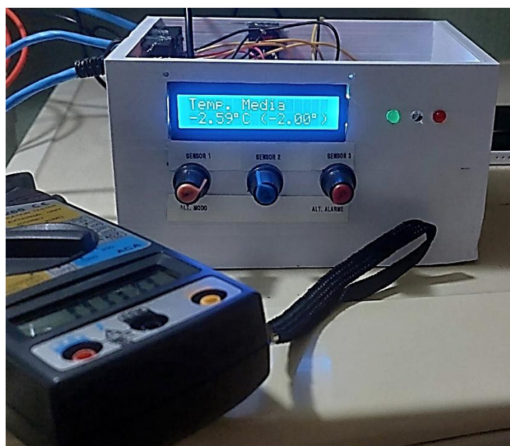
Figura 55: Última lata retirada, com temperatura de -2,59^{\circ}\text{C} medida pelos sensores.
