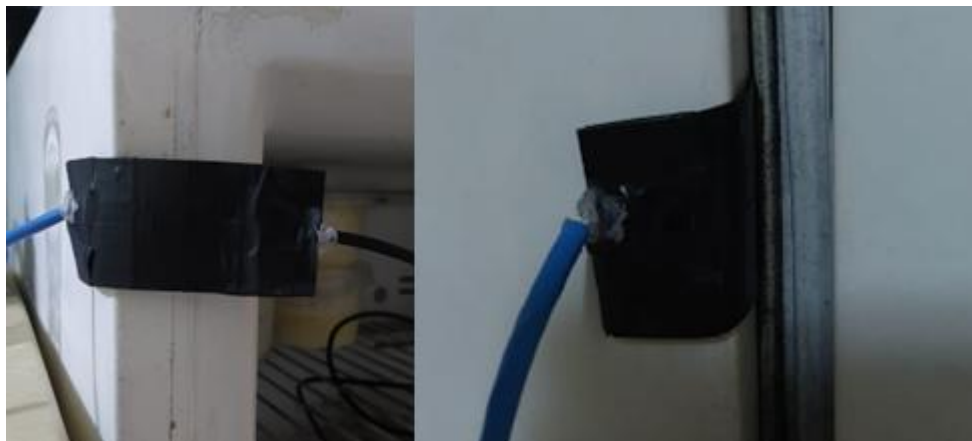
Figura 33: Fita condutora instalada na porta do refrigerador para passagem do cabo do sensor
