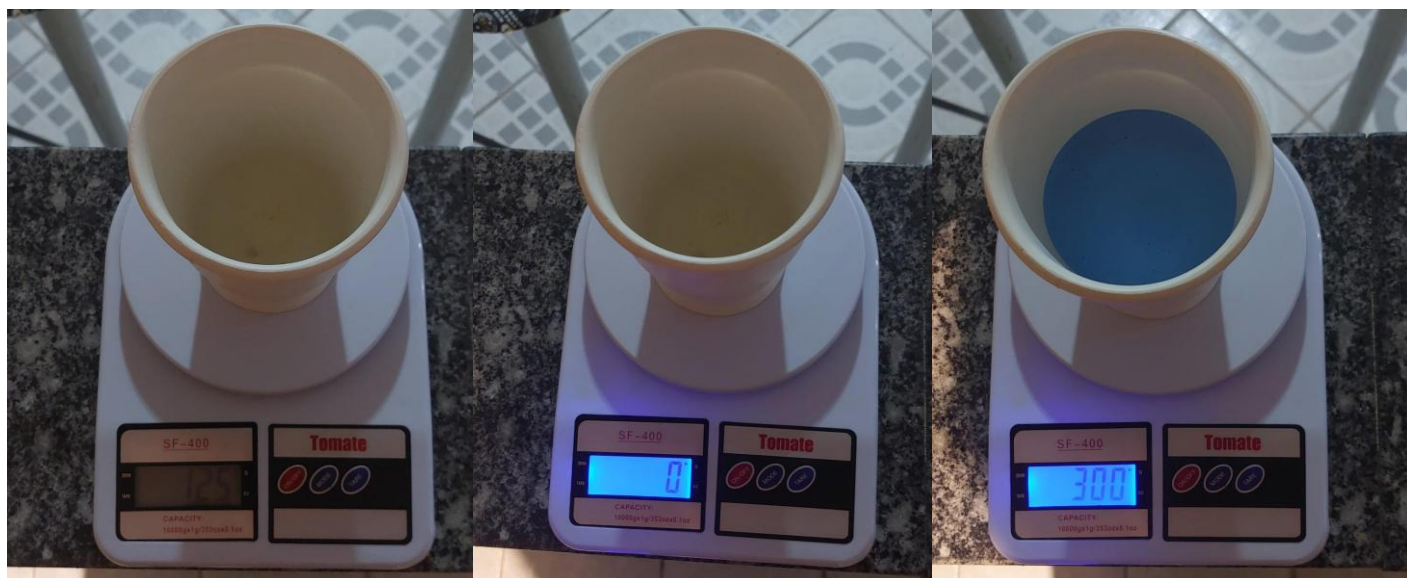
Figura 27: Pesagem do recipiente, tara ajustada e medição de 300 g de borracha de silicone azul para preparo da mistura do anel
