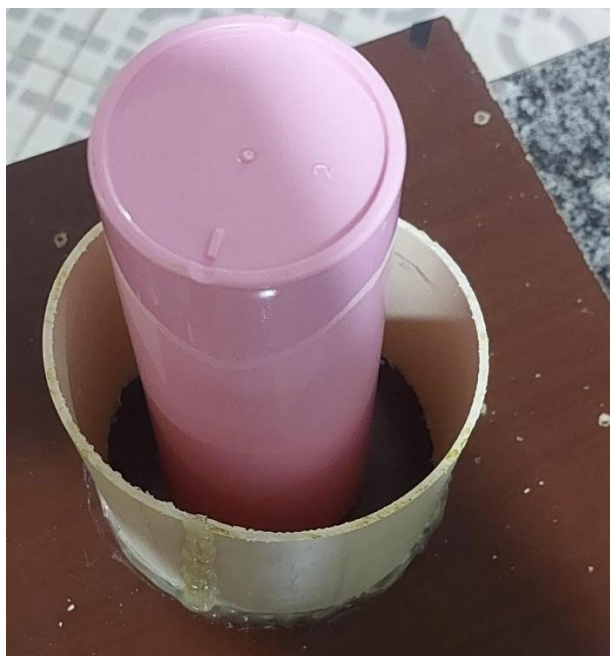
Figura 26: Copo plástico centralizado e fixado na base, formando o molde interno que definirá o diâmetro do anel
