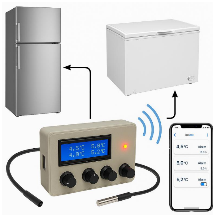
Figura 2: Ilustração do sistema UaiGelô integrado a geladeiras e freezers, com sensores, encoders, display LCD e Bluetooth.
