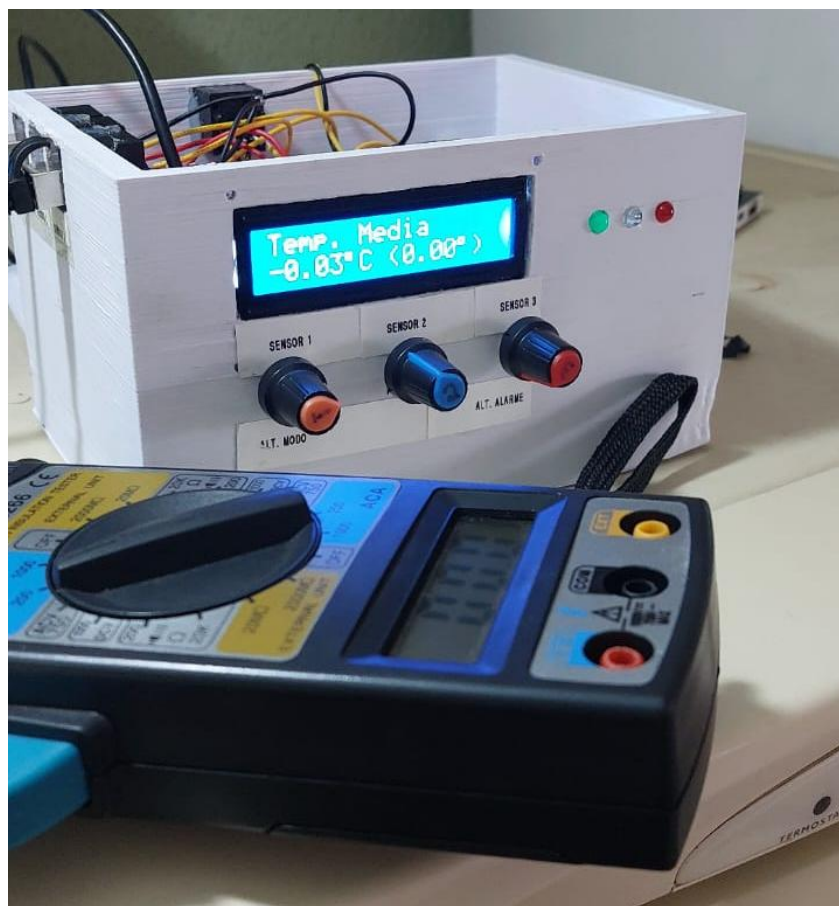
Figura 48: Temperatura medida após 12 horas de teste.
