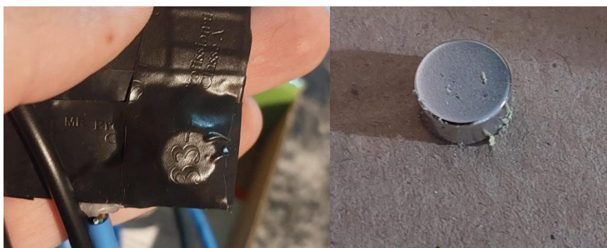
Figura 32: Detalhe da fixação do ímã de neodímio na fita condutora
