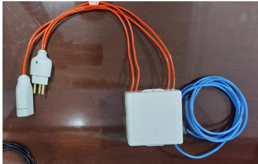
Figura 22: Case responsável por abrigar os relés e fonte de alimentação.
