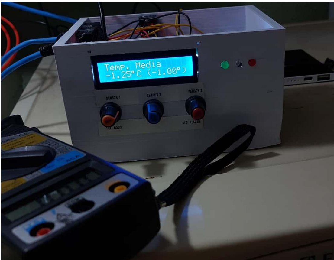
Figura 52: Temperatura interna do congelador registrada antes da retirada das latas ( -1,25\text{ }^{\circ}\text{C} ).
