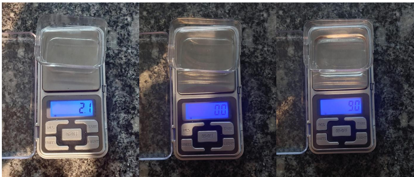
Figura 28: Pesagem do recipiente, tara ajustada e medição de 9 g de catalisador para preparo da mistura do anel.
