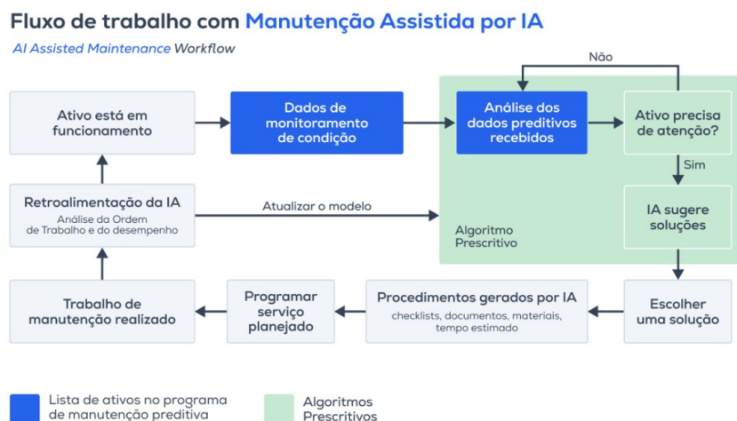
Figura 5 – Workflow da Manutenção Assistido por IA
