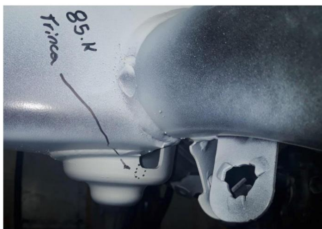
Figura 33: Falha suporte mola evidenciada em teste de bancada
