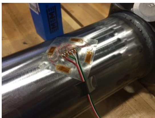
Figura 16: fixação de strain gauge
