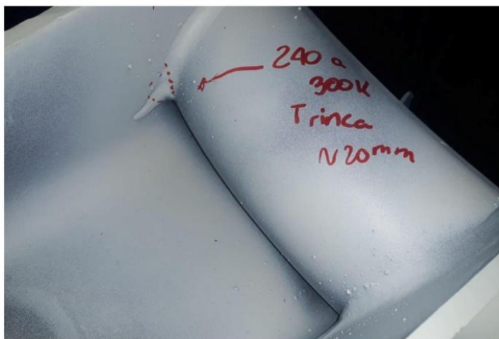
Figura 33: Falha suporte mola evidenciada em teste de bancada
