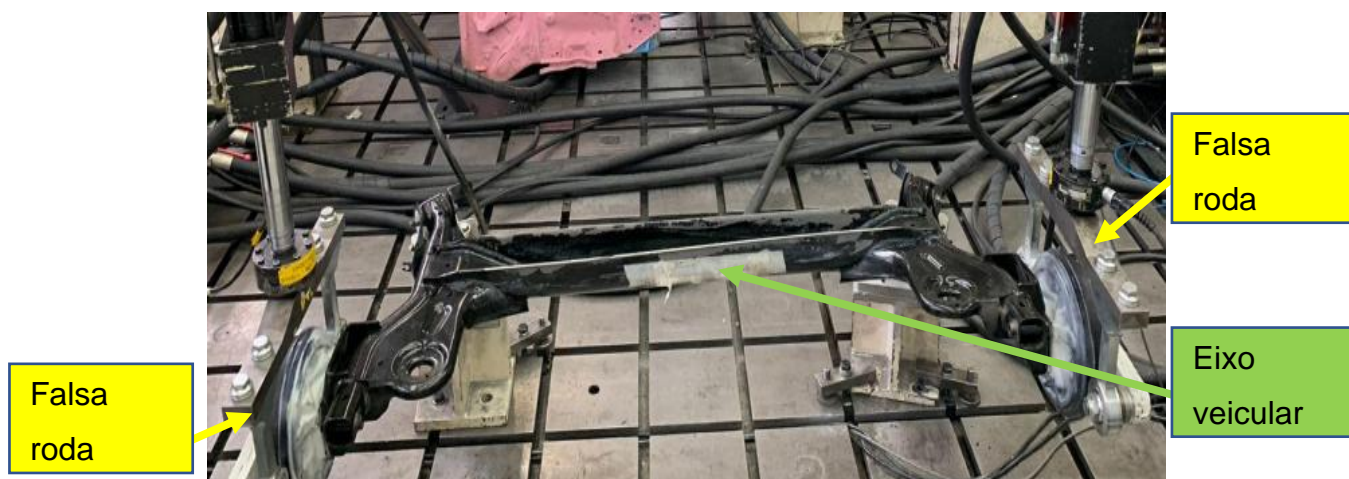
Figura 29: Montagem de prova de fadiga torcional do eixo traseiro.
