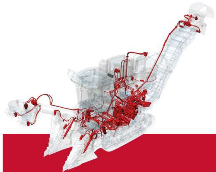
Figura 8 - Sistema hidráulico colhedora Case IH A9900
