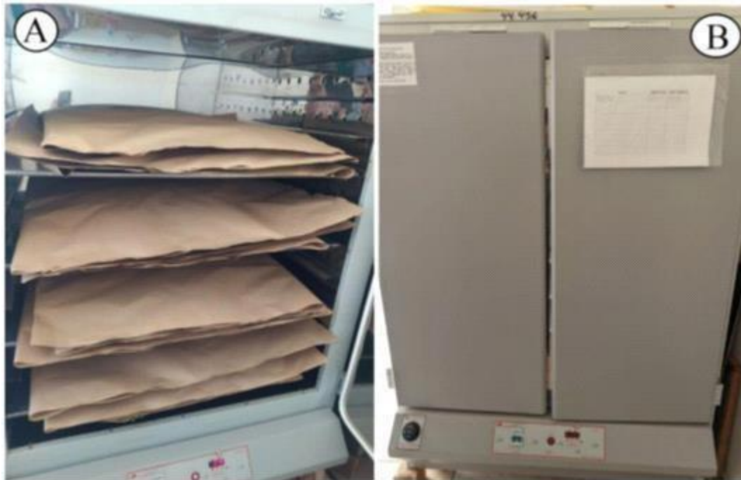
Figura 6: (A) Folhas de Cinamomo ( Melia azedarach ) acondicionadas em papel vergê e colocadas para desidratação em (B) estufa a 40° C, durante 72 horas.
