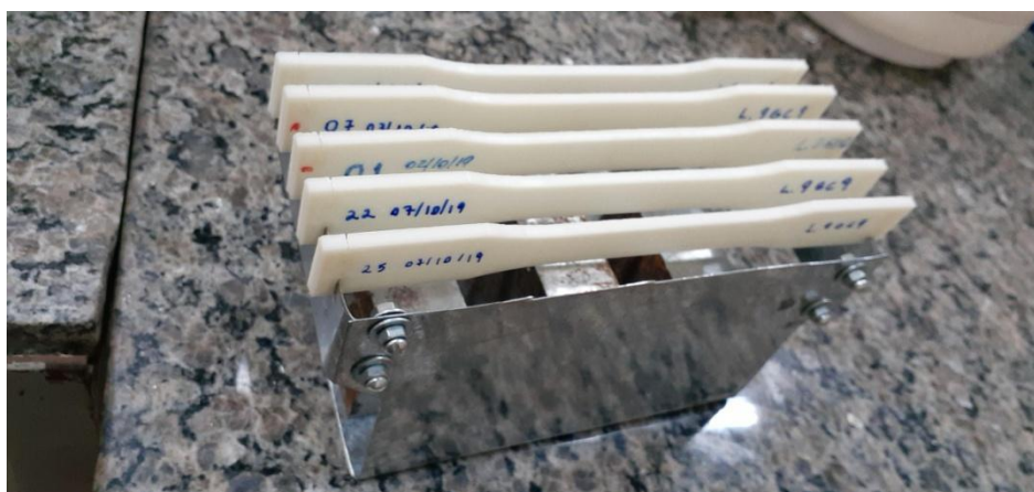
Figura 33 - Utilização dos talhos nos corpos de prova de forma a fixar no suporte
