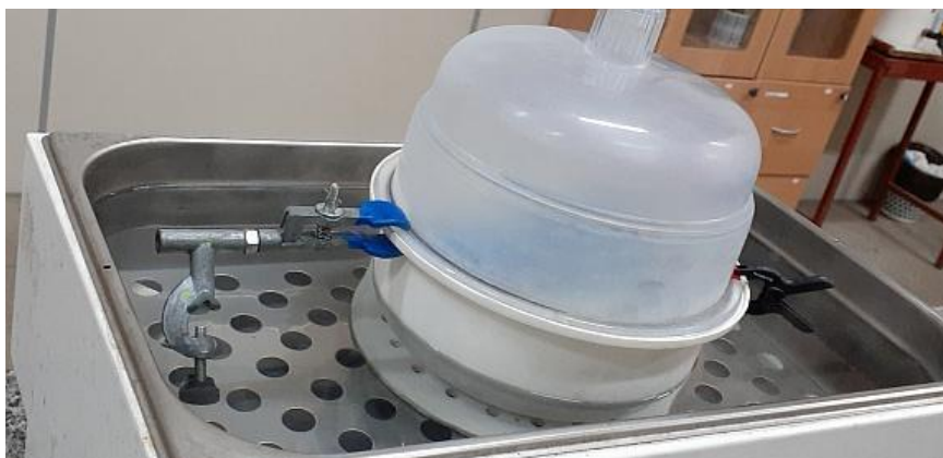
Figura 46 - Cuba parcialmente imersa na água aquecida
