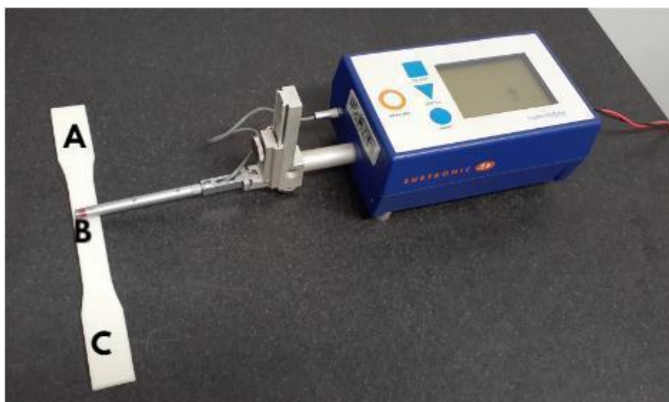
Figura 40 - Rugosímetro utilizado para medir a rugosidade superficial dos corpos de prova
