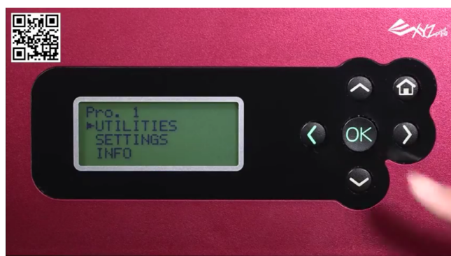
Figura 25 - Display digital para set up das configurações de impressão
