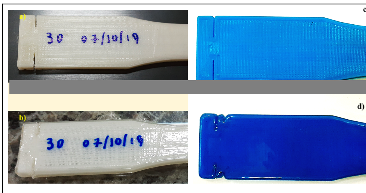
Figura 48 – Detalhes de corpos de prova antes e após tratamento superficial
