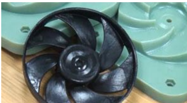
Figura 5 – Ventilador de refrigeração de motor feito em molde impresso em 3D
