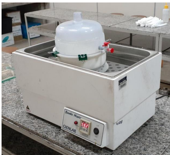
Figura 28 - Máquina da CIENLAB para banho-maria e recipiente para contenção do vapor de acetona
