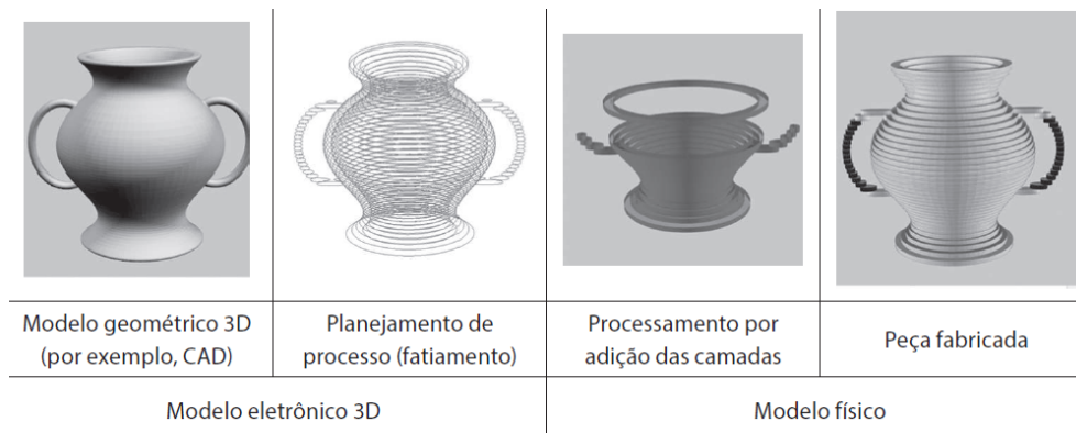
Figura 7 - Representação das principais etapas do processo de AM
