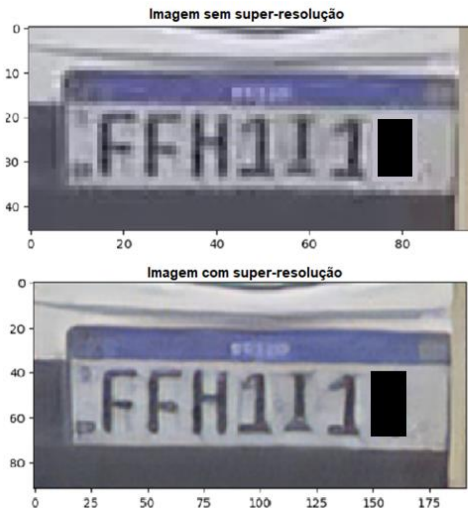
Figura 27 – Imagem sem super-resolução x Imagem com super-resolução.
