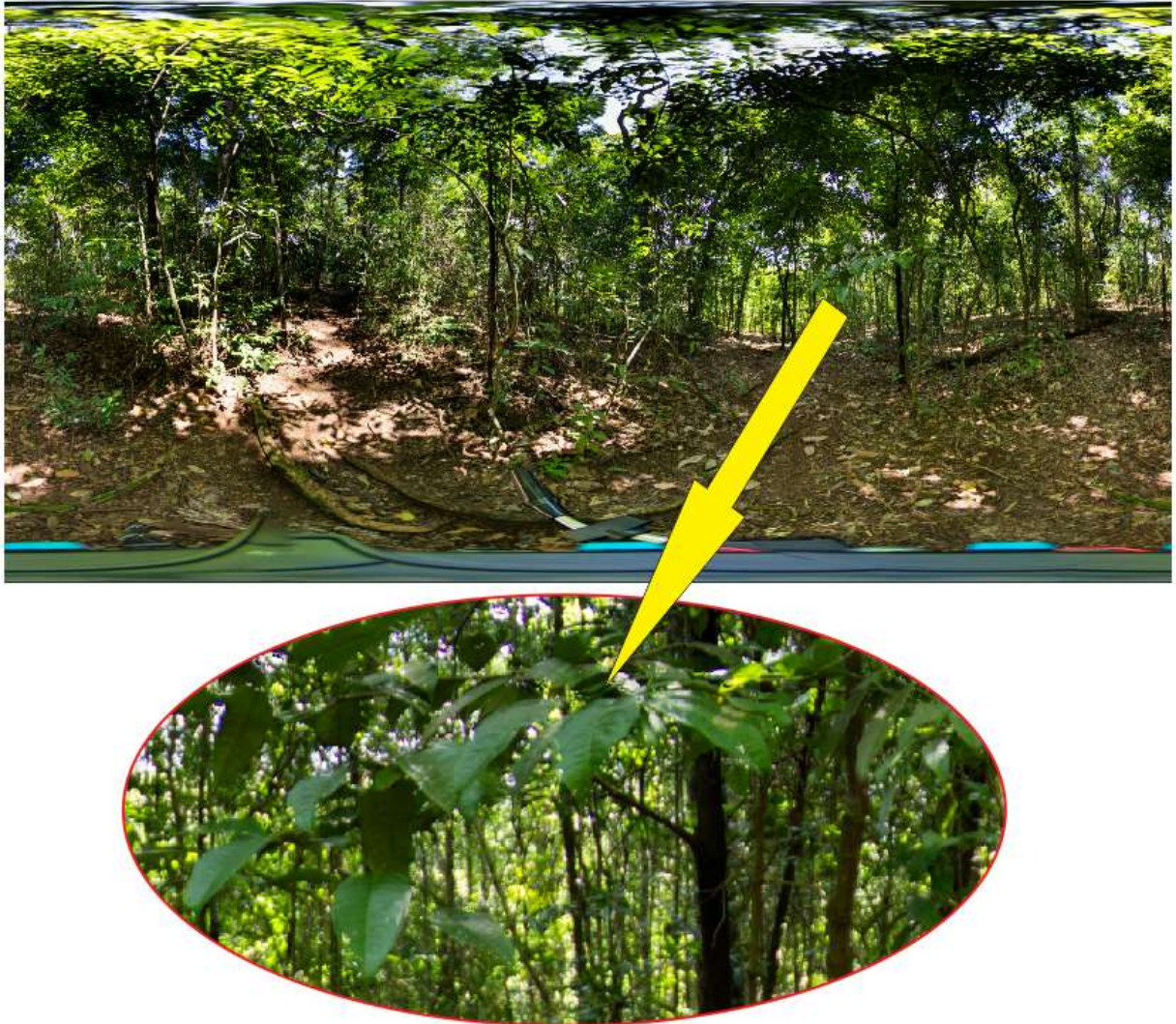
Figura 38 - Efeito fantasma (duplicação de feição) causado pelo vento.
