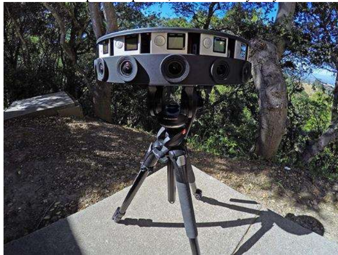
Figura 12 - Câmera polidióptrica, modelo Odyssey da marca GoPro
