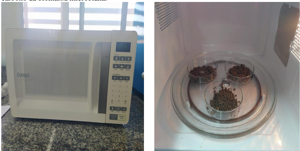
Figura 6 - Processo de irradiação das amostras em forno de micro-ondas para determinação do carbono da biomassa microbiana.
