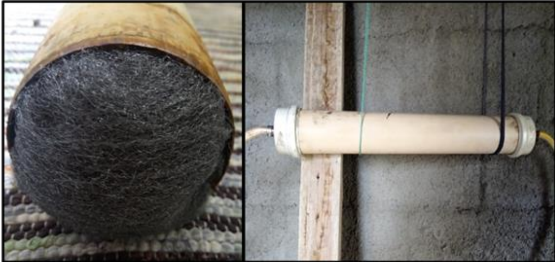
Figura 10 - Parte (Filtro com lã de aço) do protótipo do biodigestor utilizado no tratamento dos resíduos da Unidade de Alimentação e Nutrição do IFMG Campus Bambuí, 2021
