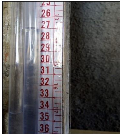
Figura 16 - Mangueira em forma de U usada para observar o deslocamento de líquido na coluna
