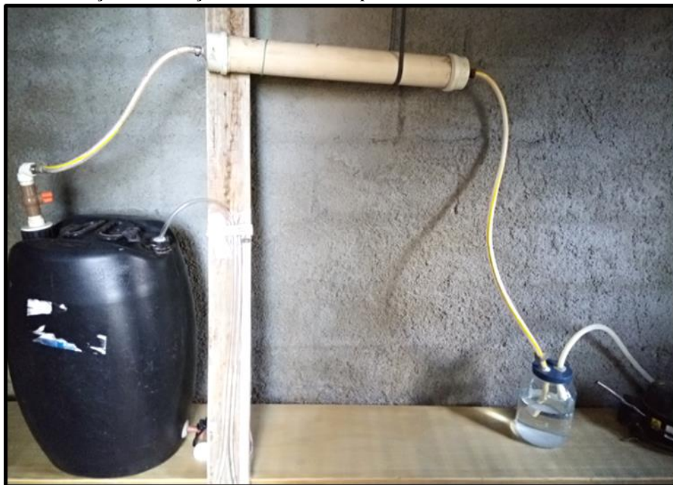
Figura 8 - Protótipo do biodigestor utilizado no tratamento dos resíduos da Unidade de Alimentação e Nutrição do IFMG Campus Bambuí, 2021
