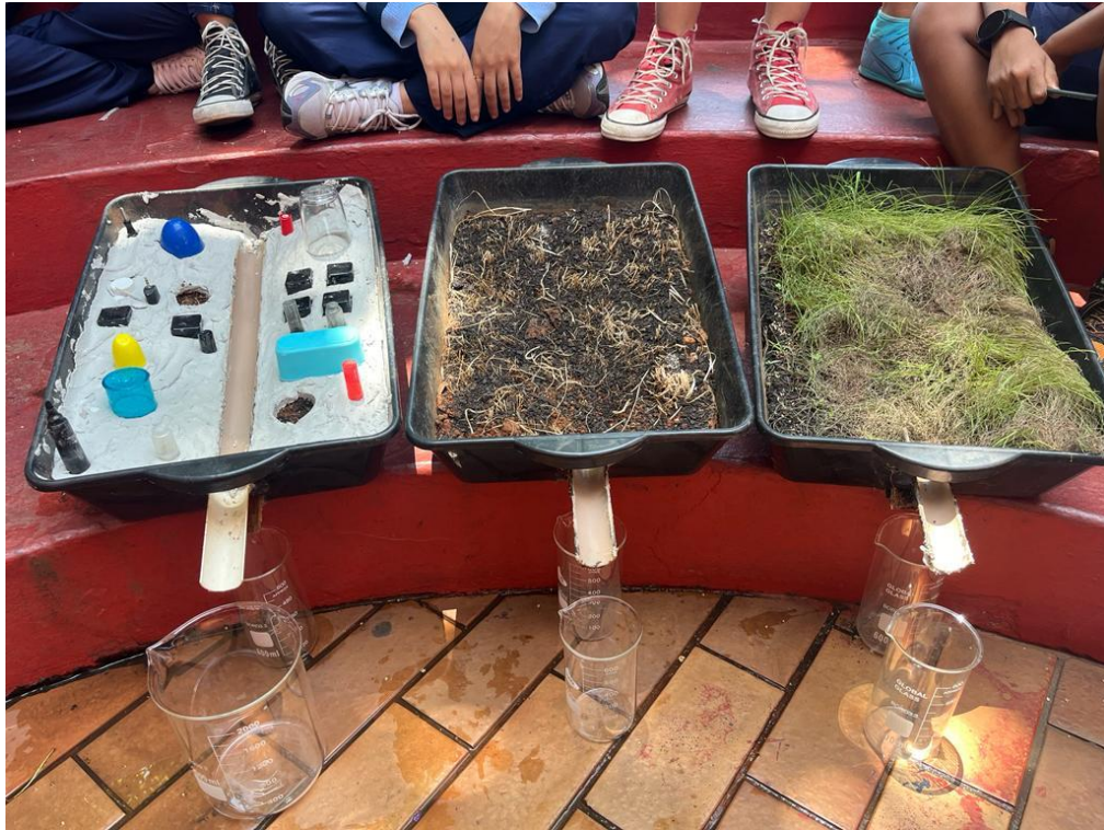
Figura 25 - Simulação de bacias com diferentes coberturas de solo
