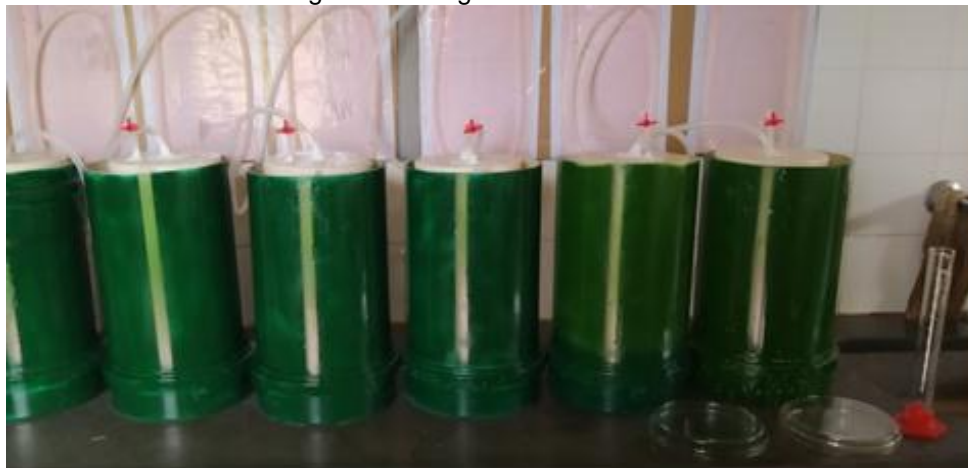
Figura 1: Biodigestores de bancada
