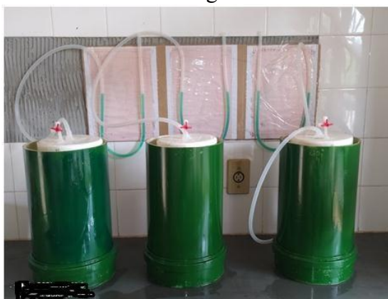
Figura 9: Biodigestores e manômetro de coluna d'água
