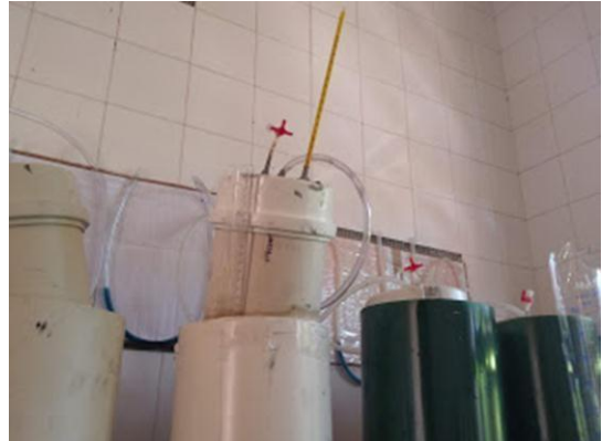
Figura 16: Termômetro de mercúrio fixado ao gasômetro
