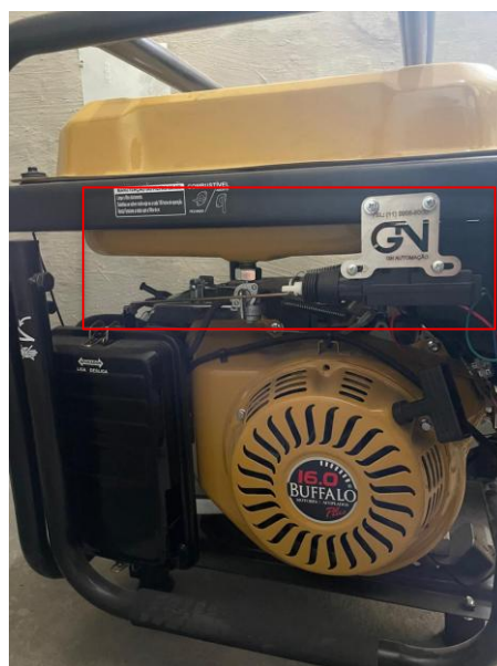
Figura 20 - Motogerador com atuador instalado.
