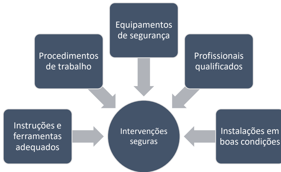
Figura 5 - Fatores chave para intervenções seguras em instalações elétricas
