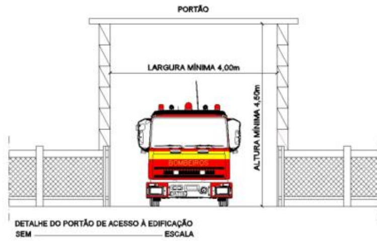
Figura 6 - Dimensões mínimas dos portões de acesso.
