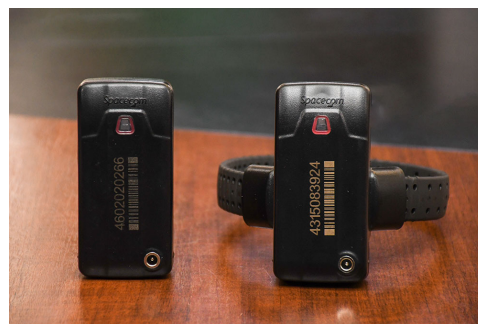
(b) Tornozeleira eletrônica com botão de pânico acoplado, utilizada em programas oficiais de monitoramento (fonte: TJMG).
