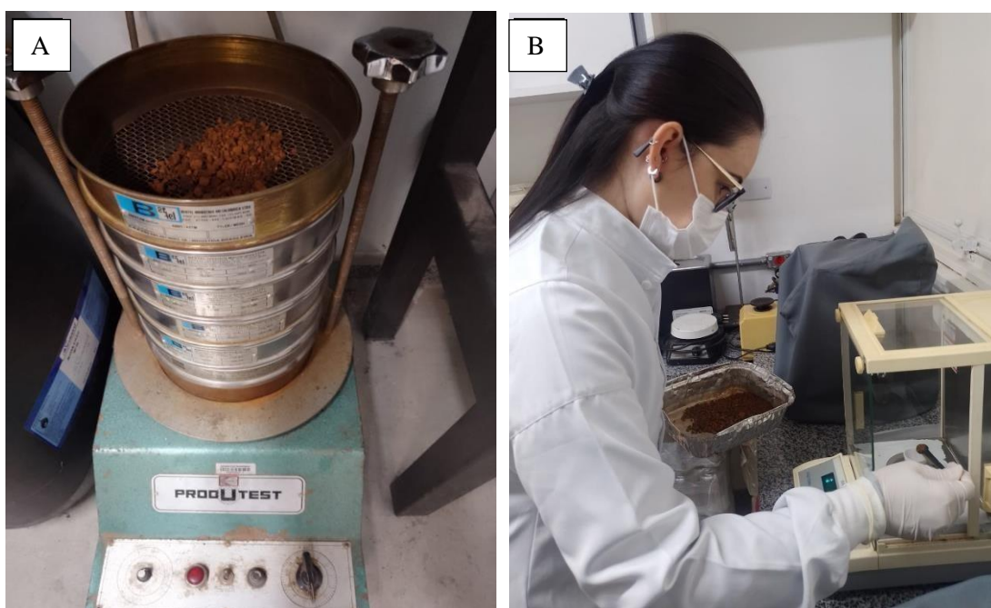
Figura 9- (A) Agitador eletromagnético e peneiras com amostras para análise granulométrica; (B) pesagem das alíquotas de amostras a serem incineradas para cálculo de teor de matéria orgânica.
