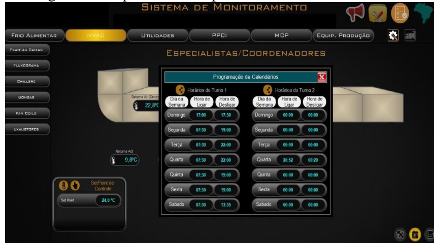
Figura 12. Supervisório Elipse. Sistema de ar-condicionado.
