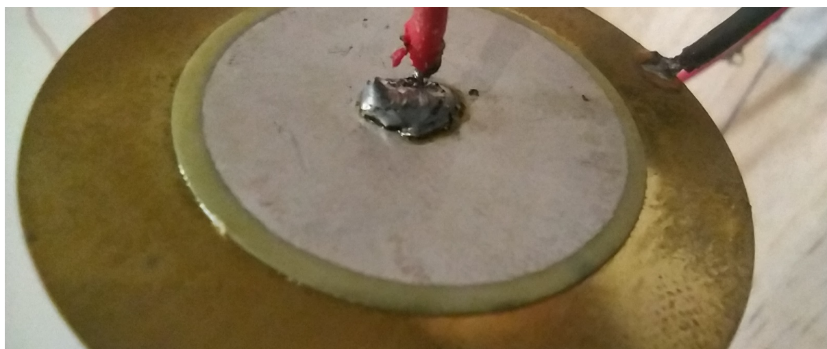
Figura 10 – Solda da pastilha na parte central da cerâmica.
