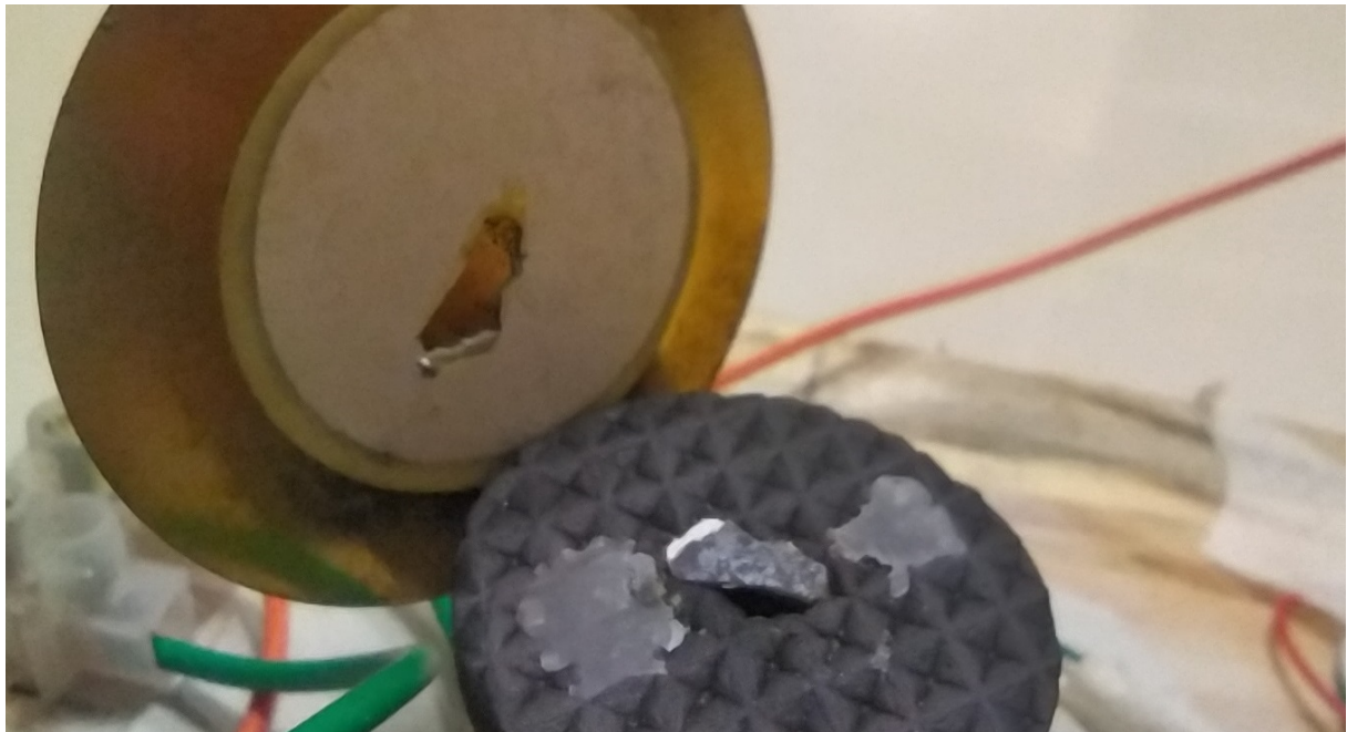
Figura 12 – Fratura do ponto de solda.
