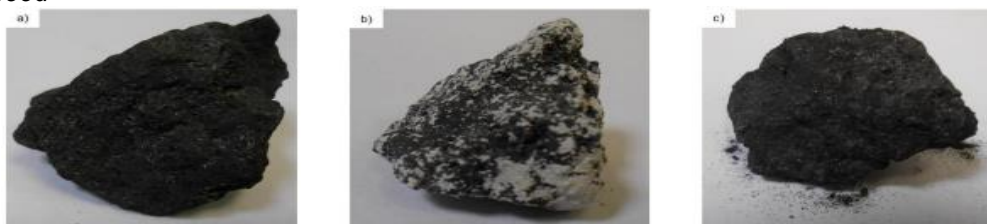
Figura 3.17 – a) Small coke sem adições; b) small coke com 3% de cal virgem; c) small coke com 3% de pellet feed
