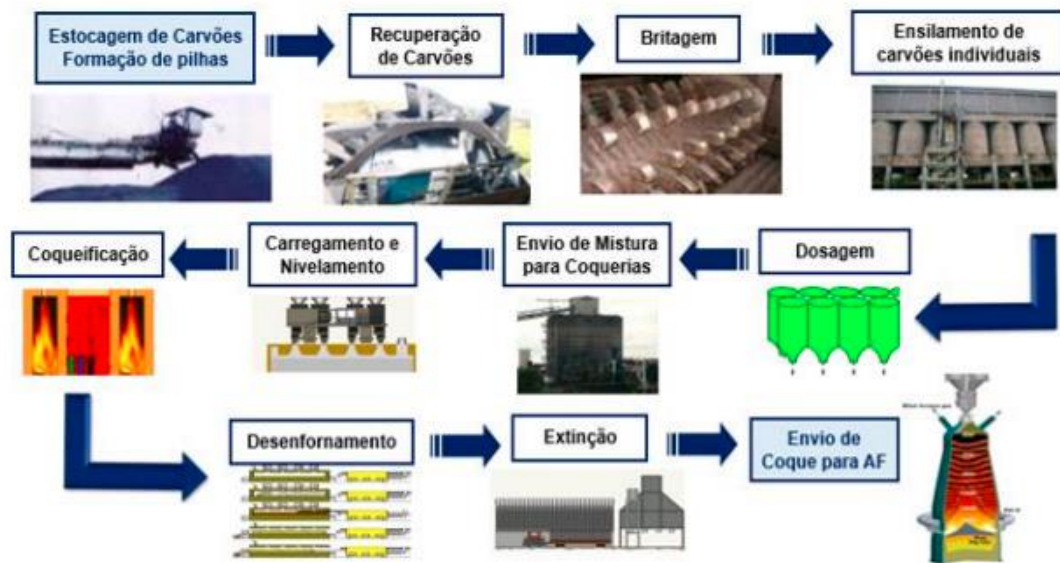
Figura 3.1 – Recebimento e preparação de carvão em usina siderúrgica a coque
