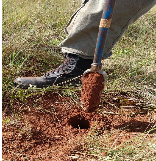
Figura 19 - Coleta de amostras de solo para análises físico-químicas.
