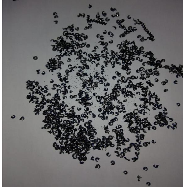
Figura 28: cavaco de corte 4º lote
