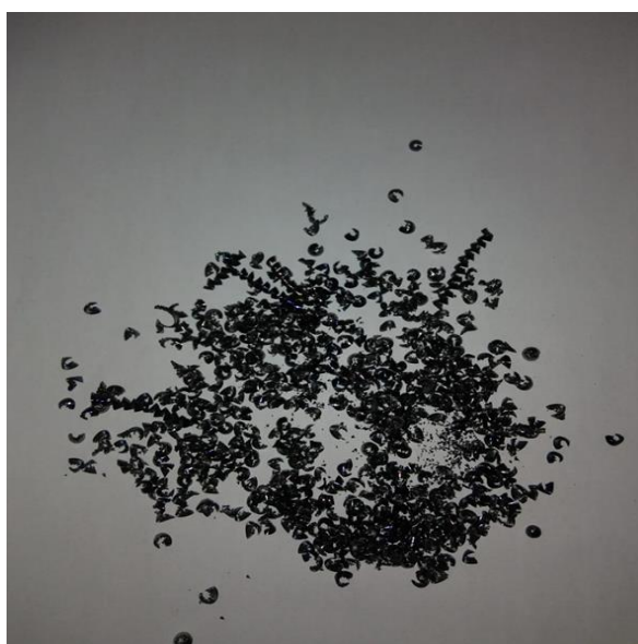
Figura 27: cavaco de corte 3º lote
