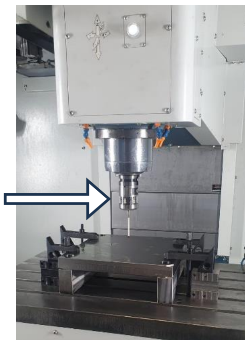
Figura 17 - Apalpador RENISHAW OMP60 em um Centro de Usinagem
