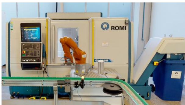
Figura 5 - Torno CNC com ferramenta acionada ROMI GL250M
