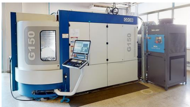
Figura 7 - Centro de Usinagem 5 eixos GROB G150
