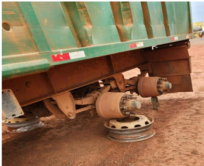
Figura 12: Suspensão precária de veículos e implementos.
