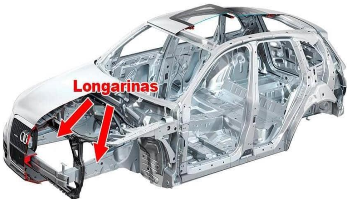
Figura 3- Automóvel com várias partes fabricadas em aço indicando as longarinas.
