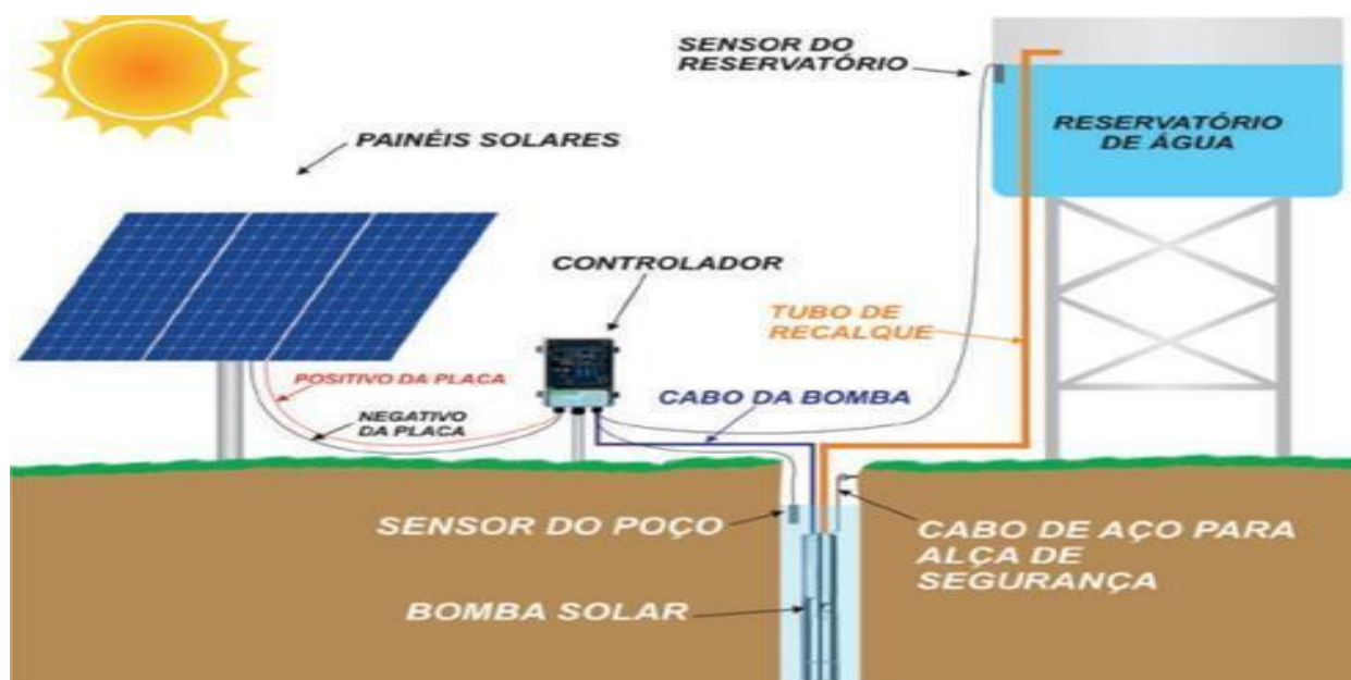
Figura 17 - Gerador de Energia Bomba Solar OFF GRID
