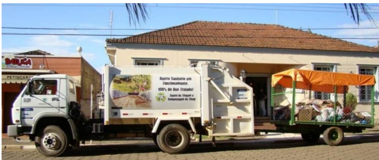
Figura – Coletor compactador de lixo com carroceria adaptada para coleta seletiva
