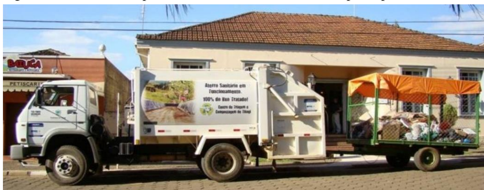
Figura 26 – Coletor compactador de lixo com carroceria adaptada para coleta seletiva
