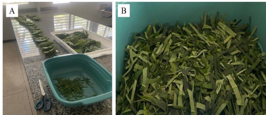
Figura 4 – Preparo do material vegetal para extração de óleo essencial. A) Folhas sendo preparadas para extração e B) Material vegetal em granulometria aproximada de 5 cm x 0,5 cm
