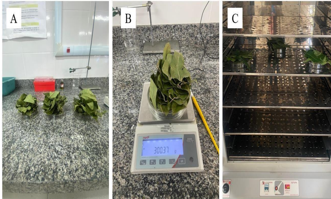
Figura 3 – Determinação dos teores de umidade e matéria seca do material vegetal. A) Amostragem em triplicatas e B) Determinação da massa úmida e C) Amostras secando em estufa para determinação da massa seca
