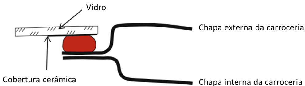
Figura 28 - Seção transversal de uma colagem de para-brisa.
