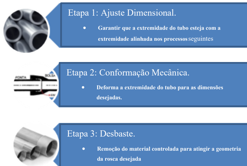
Figura 1 – Etapas do processo de preparação da extremidade de tubos
