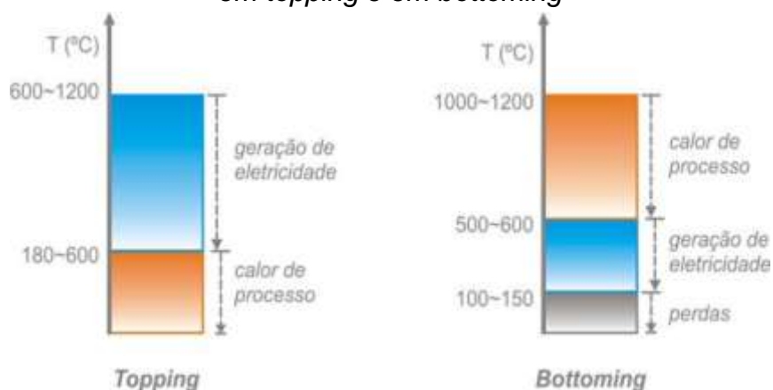
Figura 20 - Faixa típica de temperatura para os sistemas de cogeração em topping e em bottoming
