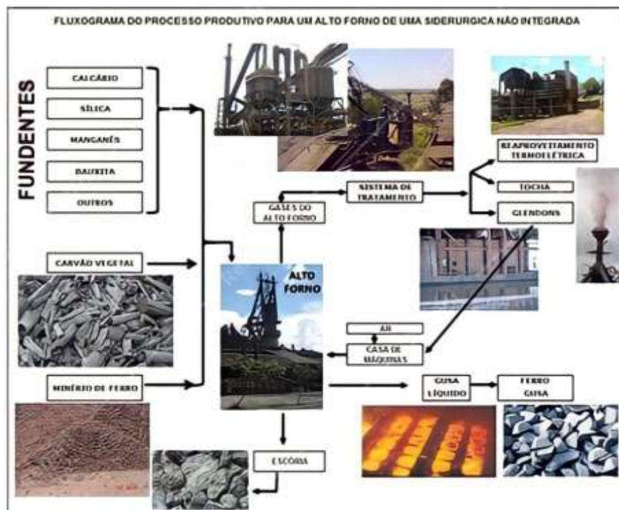
Figura 1 - Produção de ferro gusa em uma indústria Siderúrgica não Integrada
