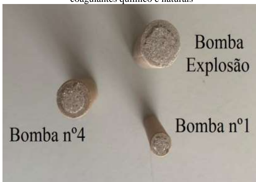
Figura 7 – Tubos prensados, com lodo da estação de tratamento das águas residuárias com coagulantes químico e naturais
