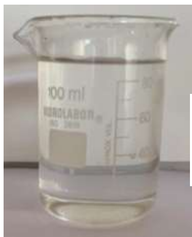
c) Água residuária tratada com sementes de acácia-branca triturado em 6mm (T2).
