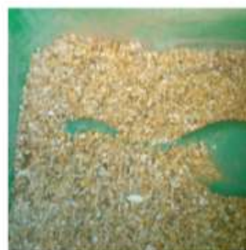
Figura 11 – Preparo e trituração dos coagulantes naturais escolhidos
