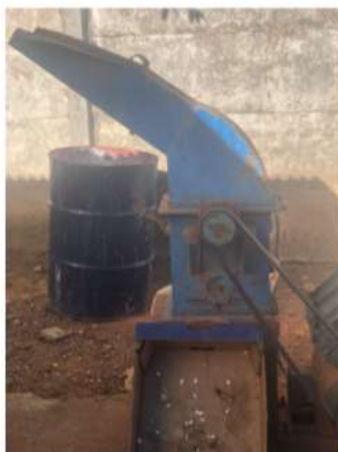
Figura 11 – Preparo e trituração dos coagulantes naturais escolhidos
