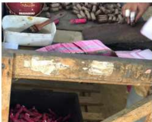
e) Enfeitação e arrematação de bombas de solo.
