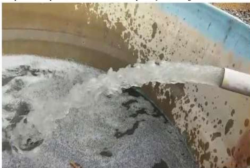
Figura 13 – Água residuária tratada com coagulante natural passando na caixa filtro para reúso para fins menos nobres na produção dos fogos de artifícios
