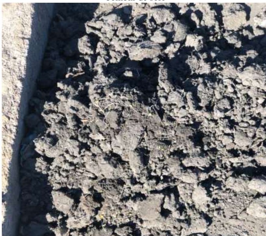
Figura 5 – Acondicionamento de lodo seco em até 2% de umidade para uso na fabricação de bombas de solo
