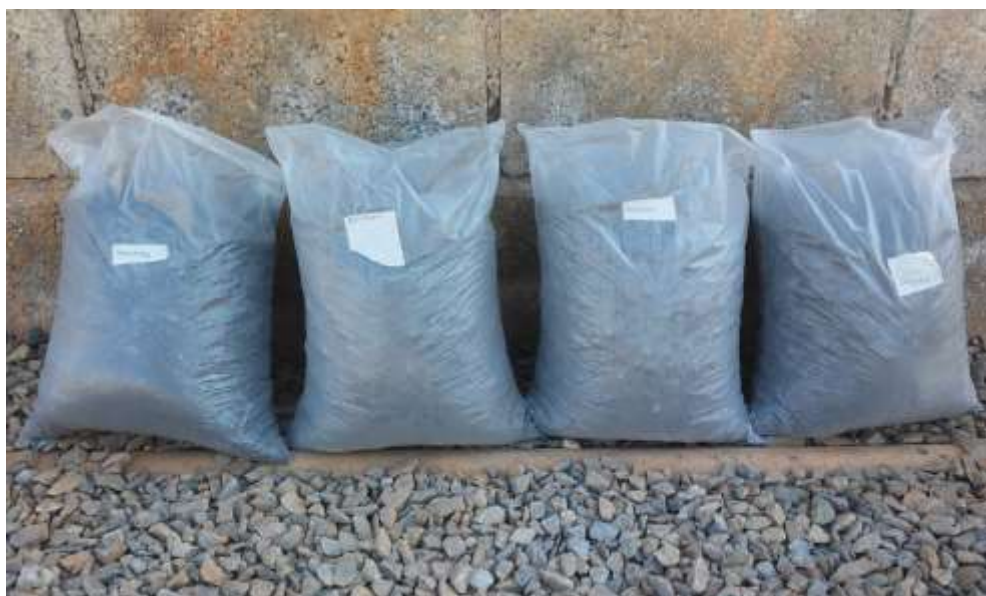
Figura 4 – Lodo da estação de tratamento com uso de coagulantes naturais para a realização da característica físico-química e classificação quanto à periculosidade.
