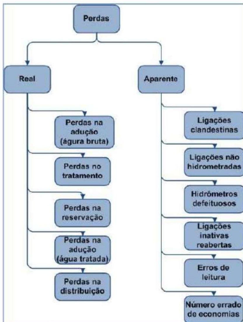
Figura 16: Tipos de perdas existentes no SAA
