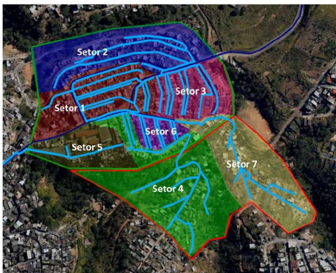
Figura 62: Setores de abastecimento da proposta de melhoria
