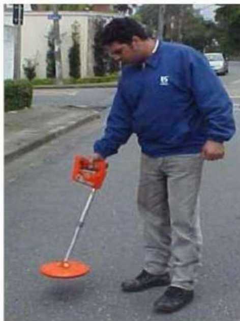
Figura 26: Detector de massa metálica
