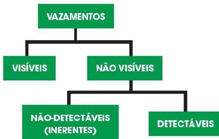
Figura 42: Classificação dos vazamentos segundo a IWA
