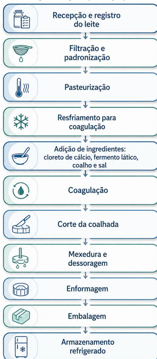
Figura 1 - Fluxograma de produção do queijo Minas Frescal
