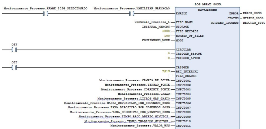
Figura 36 - Lógica para gravação de parâmetros em arquivos tipo CSV.
